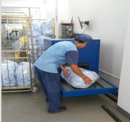
Este sistema conta com um dispositivo de RDF (Radio frequencia), ultra moderno de rastreabilidade que funciona com micro chips que são colocados em todas as peças do enxoval. As quais permitem reconhecer o início do uso, quantas vezes foi lavada, o Hospital de procedência, e toda a informação que seja necessária para ser armazenada, e posteriormente analisada. Transformando assim essas peças em roupas Hospitalares Inteligentes.
